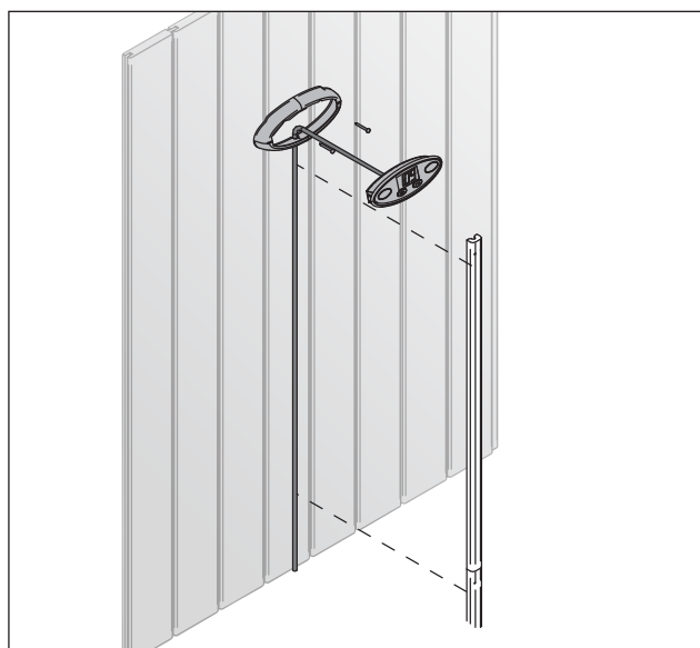
Rys. 9. Instalacja panela sterującego
