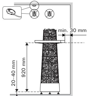
**HUOM!** Kaiteen asennusetaisyyss alittaa kiukaan asennusohjeessa mainitut suojaetäisyys. Kaiteen ja kiukaan yhdistelmä on kuitenkin testattu huolellisesti ja etäisyys on todettu riittäväksi. Lue myös kiukaan asennusohje.
