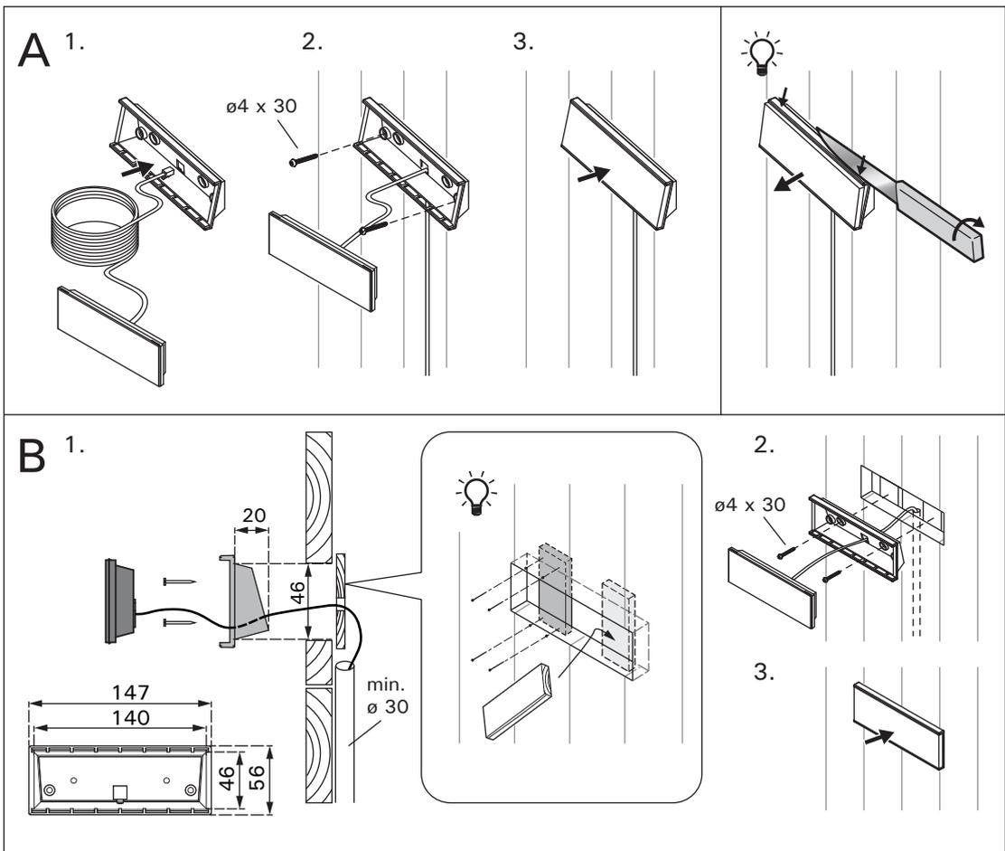
**Фигура. 8** Застопоряване на контролния панел
