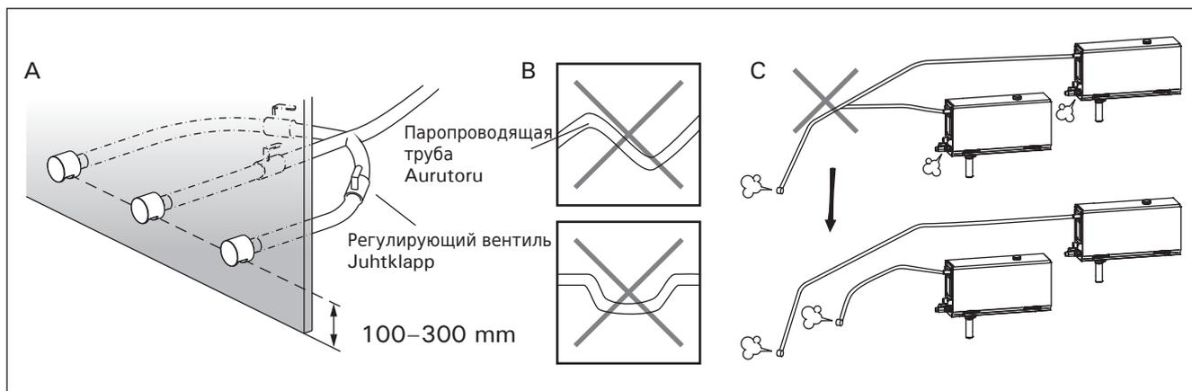
Рисунок 7. Паровые сопла и трубы
