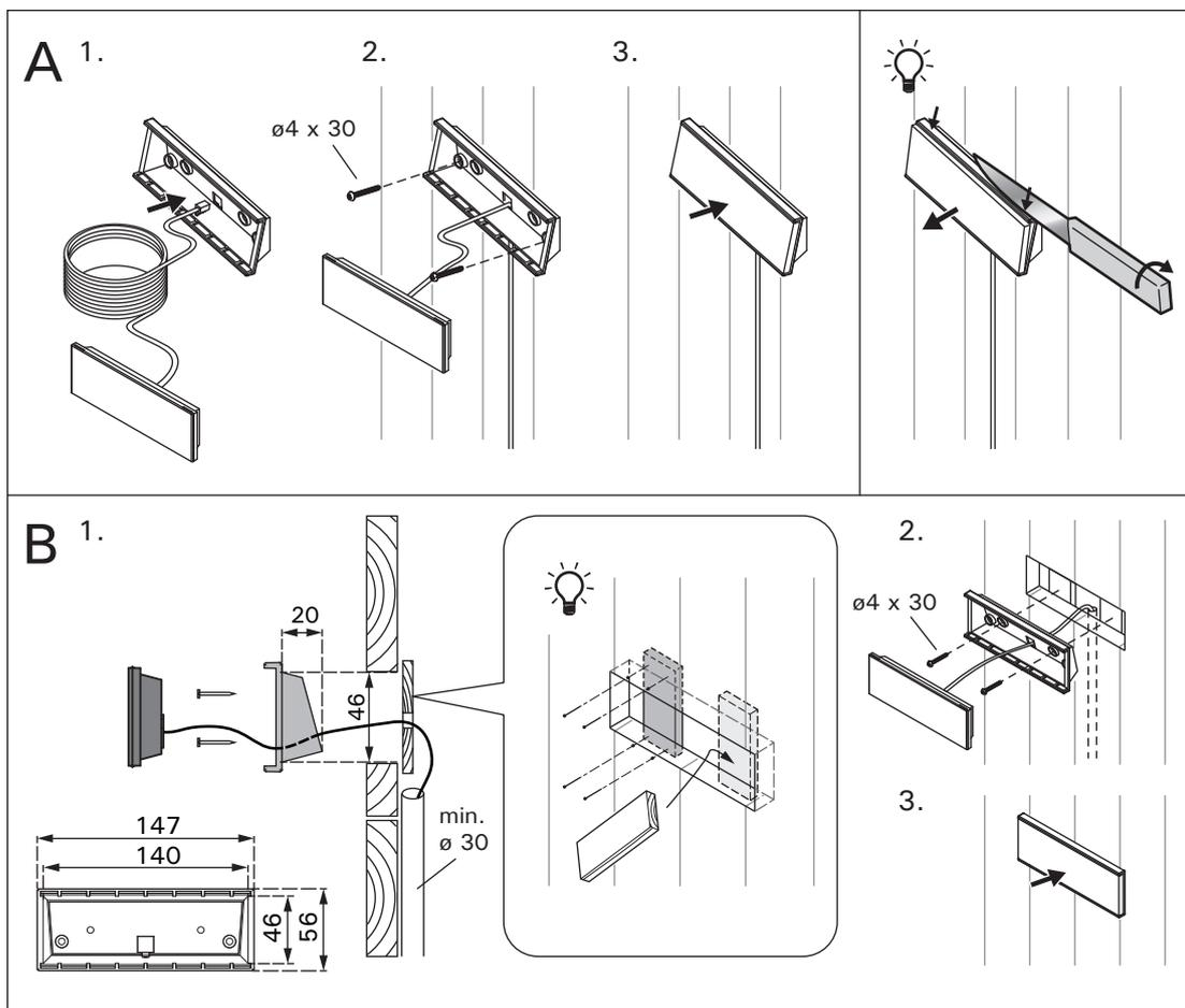
Рисунок 8. Установка панели управления
