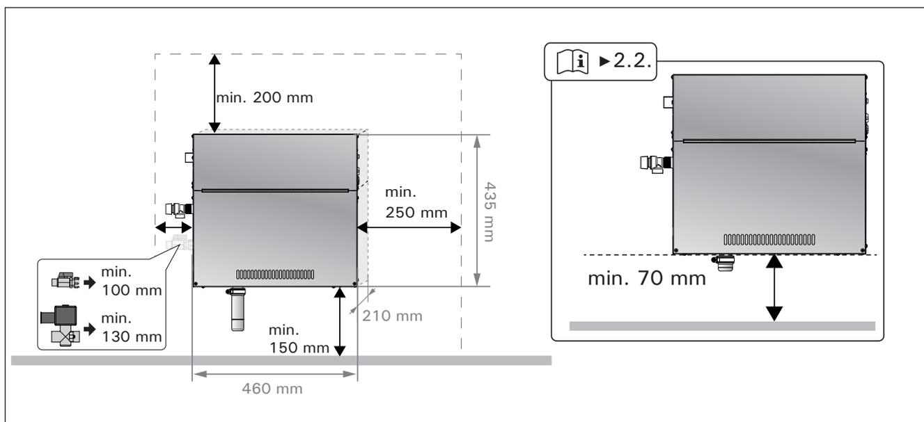
Rysunek 4. Dane pomiarowe do montażu
