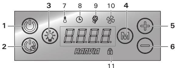
1. Включение/выключение парогенератора
