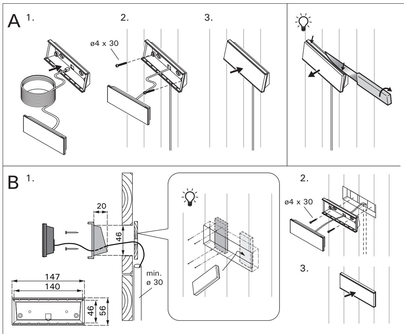
Rysunek 8. Mocowanie panelu sterującego
