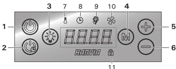
1. Бутон за пускане / спиране на парогенератора
