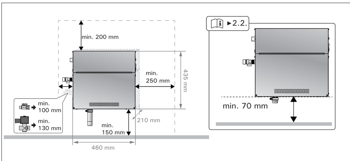
Фигура. 4 Измервания за монтаж
