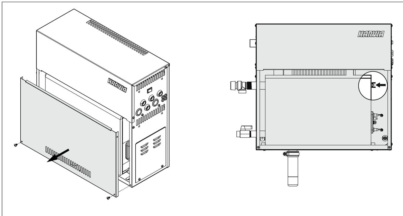
Rysunek 9. Restartowanie bezpiecznika termicznego
